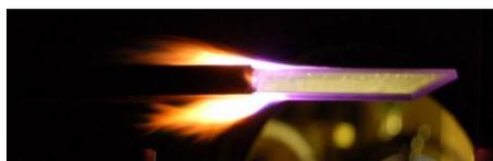
Рис. 4. Воспламенение спирта с помощью поверхностного СВЧ-разряда в условиях сверхзвукового воздушно-
