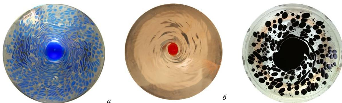
Рис. 3. Эволюция формы несмешивающейся примеси в составном вихре ( $H = 40$  см,  $V_o = 150$  мл): а) подсолнечное масло  $\Omega_d = 1170$  RPM,  $R_d = 5$  см, б) подсолнечное масло  $\Omega_d = 870$  RPM,  $R_d = 7.5$  см, в) нефть  $\Omega_d = 560$  RPM,  $R_d = 7.5$  см.
