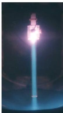
Рис. 3. Воспламенение сверхзвукового пропан-воздушного потока в условиях импульсного электродного разряда в канале без застойной зоны.
